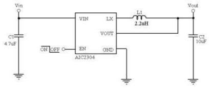
Fig. 1 Fixed Step-Down DC/DC Converter
