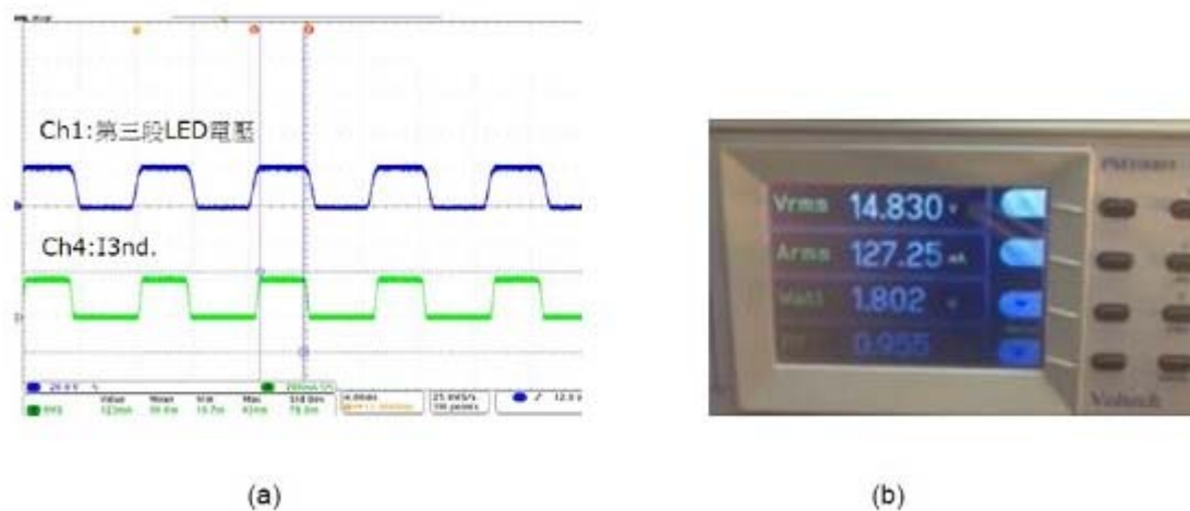
圖7 (a)第三段LED的電壓電流波形(b)測試數據
